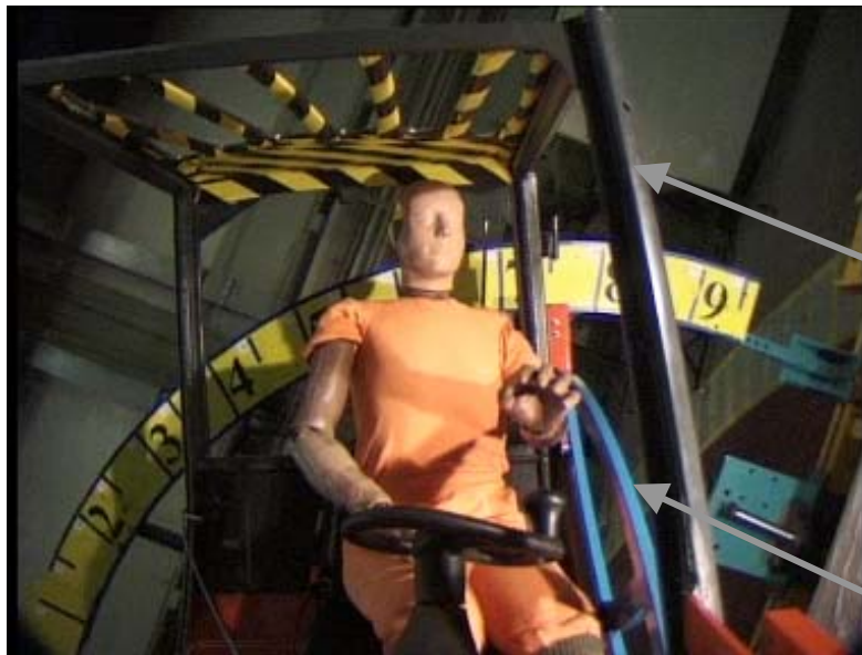
Bild 7: dynamischer Kippversuch mit mitkippender Kamera
