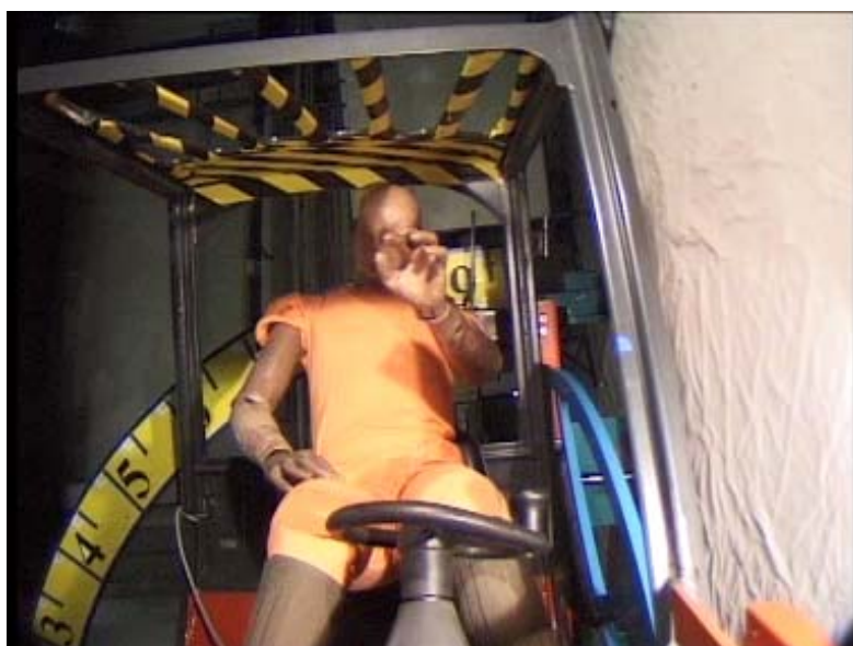
Bil 9: dynamischer Kippversuch – Aufschlag
