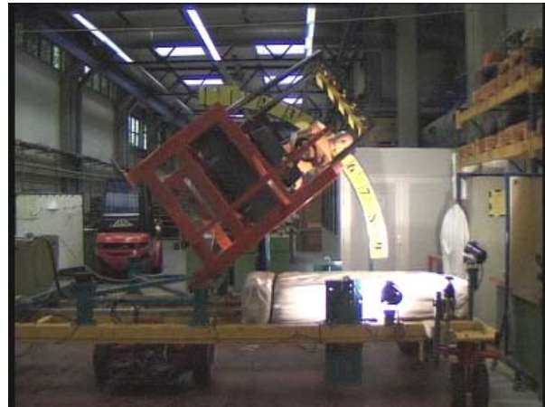
Bild 6: dynamischer Kippversuch mit einem Winkel von ca. 45°
