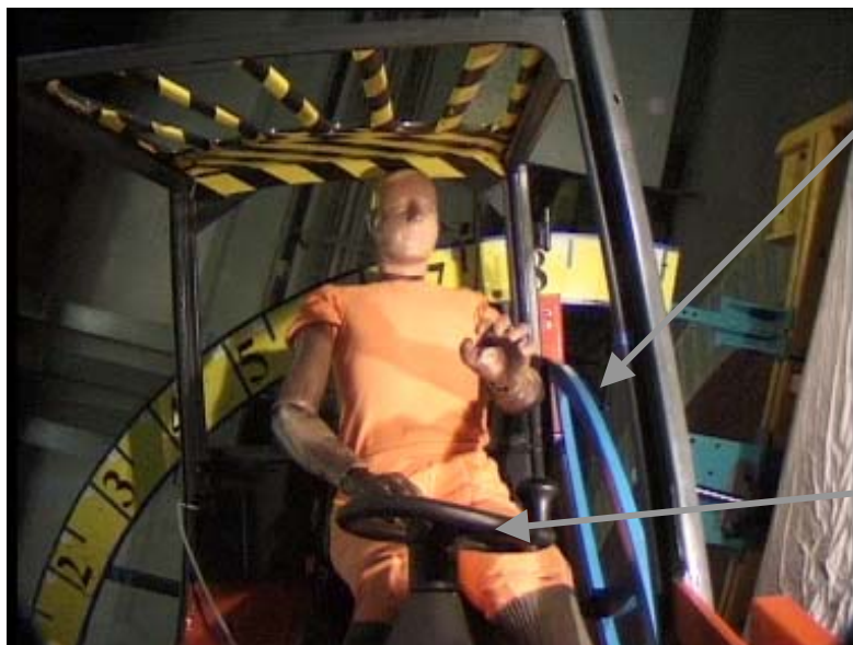
Bild 8: dynamischer Kippversuch bei ca. 76°
