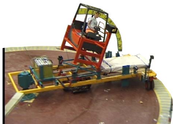
Bild 2: Kippversuch mit einem Dummy
